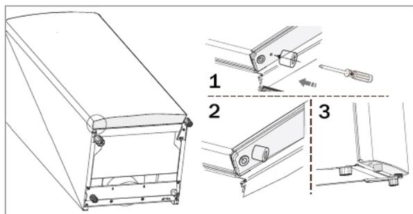
Kippen Sie das Gerät leicht nach hinten und blockieren Sie es in dieser Position. Befestigen Sie den beiliegenden Sicherheitsfuß mithilfe der Schraube in die vorgesehene Bohrung auf der Türunterseite.
