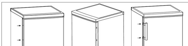
Entnehmen Sie die Abdeckkappen an der Türaußenseite und schrauben Sie den Griff mit den beiliegenden Schrauben in den darunterliegenden Bohrungen fest. Setzen Sie die im Lieferumfang enthaltenen Schraubenabdeckkappen auf.
